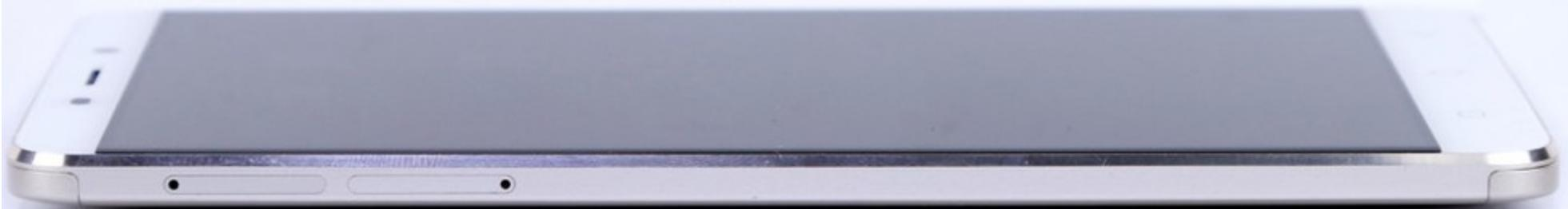
在机身左侧为两个SIM卡槽，其中上方为Micro SIM卡槽，下方卡槽则可以安放Micro SD或者Nano SIM卡，该机支持最大64GB存储扩展，360奇酷极客版可通过软件切换双卡均支持4G。
