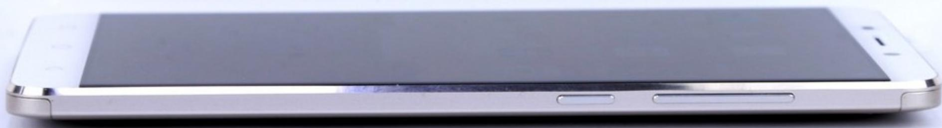
360奇酷极客版机身侧面设计中规中矩，符合用户主流的使用习惯，在机身右侧则分别为锁屏键以及一体式音量控制键。锁屏键位于下方，更加靠近机身中部，完成锁屏操作也相对轻松。
