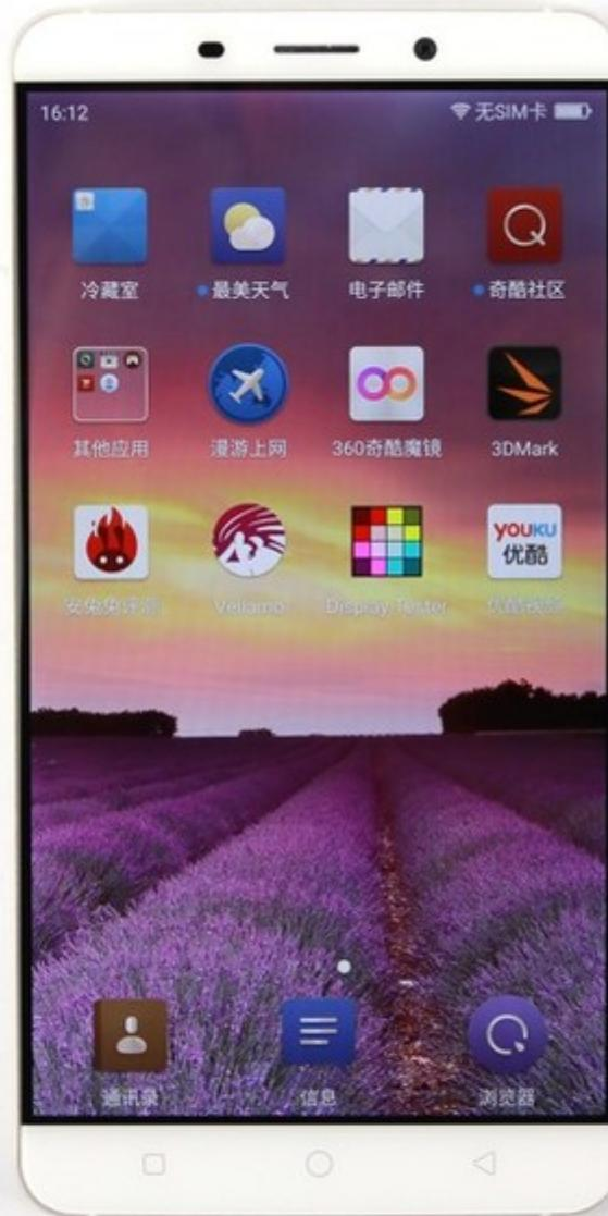
就该机正面设计而言，最突出的特点就是高达83%的屏占比，十分大气、美观。正面配备了一块490PPI 2K分辨率(2560x1440像素)的夏普6英寸屏幕，拥有不错的显示效果。
