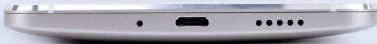
在机身底部，依次为麦克风、Micro USB接口以及扬声器。尽管没有采用Type-C接口，360奇酷极客版还是支持9V\2.2A快速充电，可以让用户充分利用碎片化时间进行充电。
