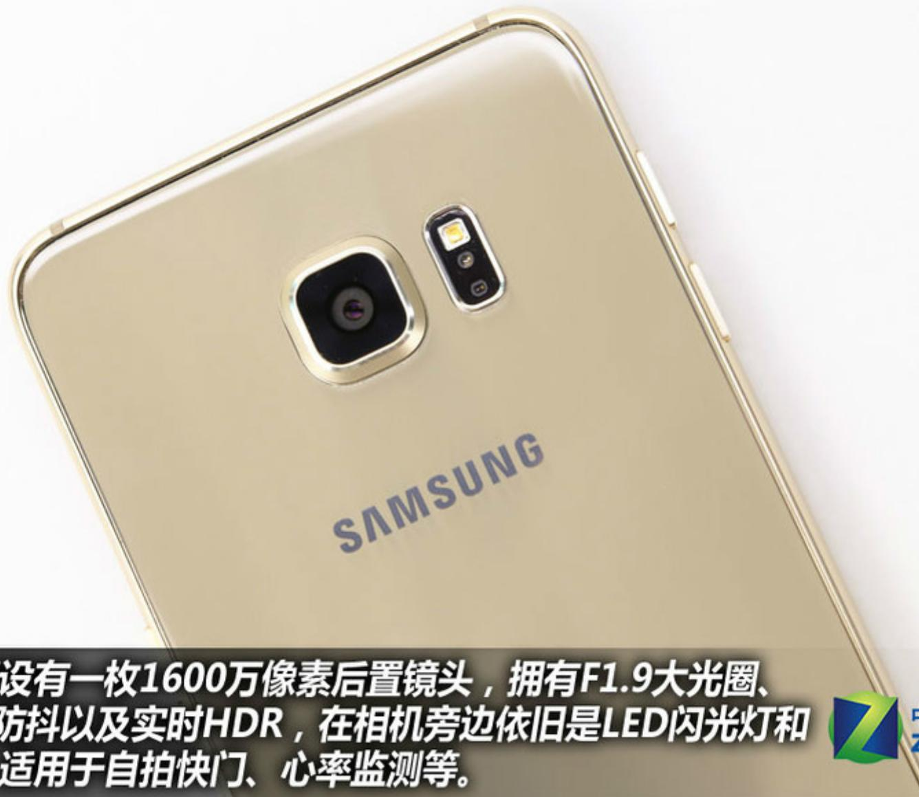
该机背部设有一枚1600万像素后置镜头，拥有F1.9大光圈、支持OIS光学防抖以及实时HDR，在相机旁边依旧是LED闪光灯和红外感应器，适用于自拍快门、心率监测等。
